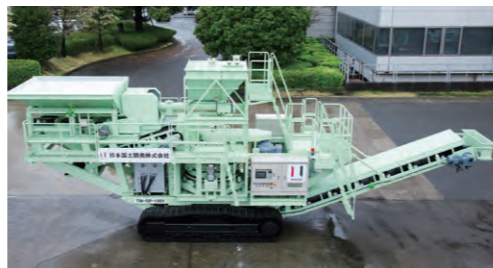
TMSP1500 (自走式一体型) 特殊条件(狭陰ヤード等)向けプラント 【処理能力】300m 3 /日 【NETIS登録】自走式回転式破碎混合機KT-200094-A
