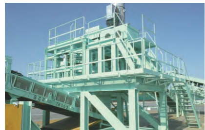
TM2250 大規模工事向けプラント 【処理能力】強化型 1,500m 3 /日・標準型 1,000m 3 /日
