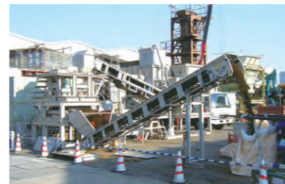
TM1000 特殊条件(試験施工等)向けプラント 【処理能力】110m 3 /日
